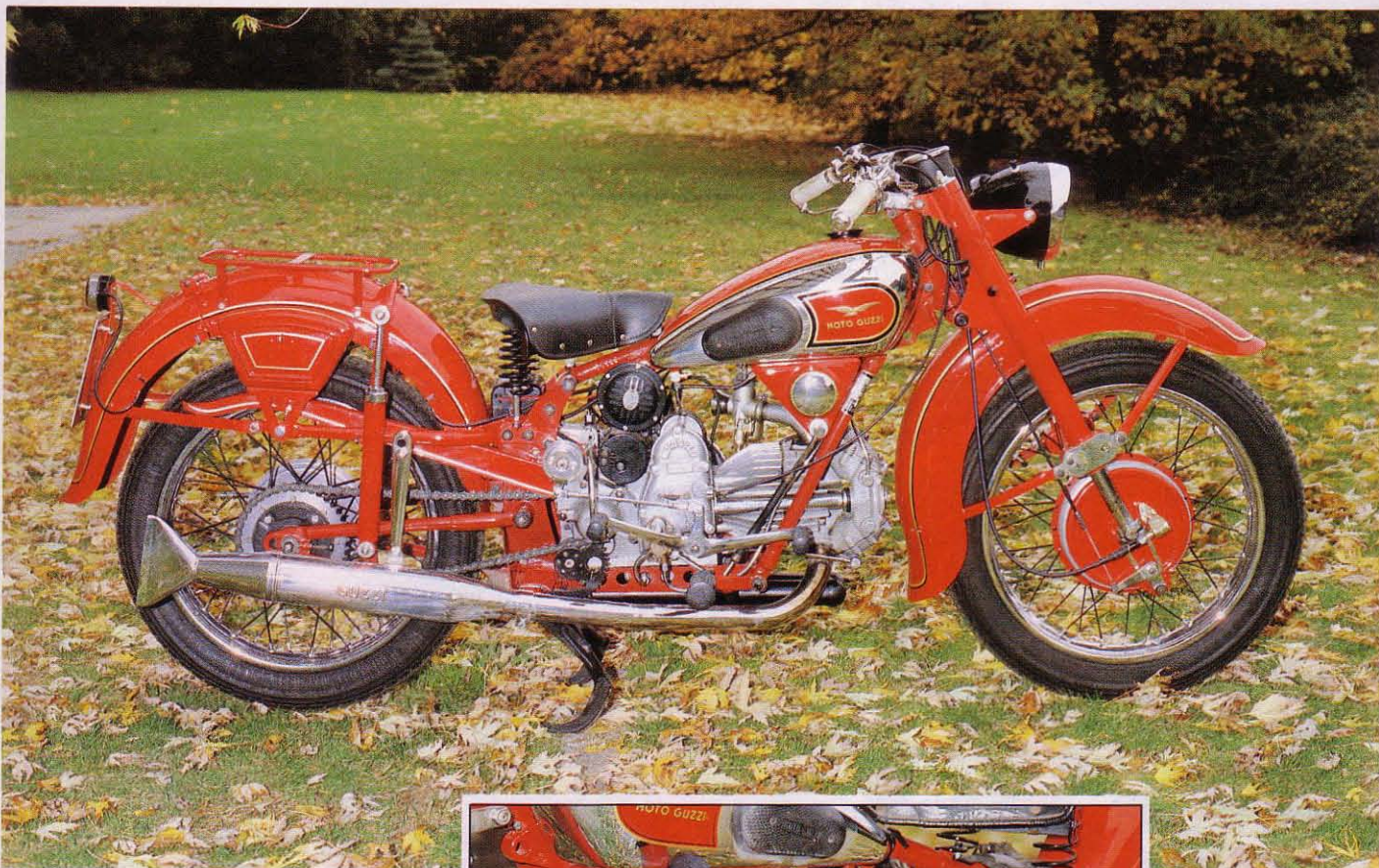
Mit Aluzylinder und gekapselten Ventilen (Modell Astore, oben) erwies sich die Vorkriegs-Konstruktion (unten) auch nach dem Krieg noch als konkurrenzfähig.
