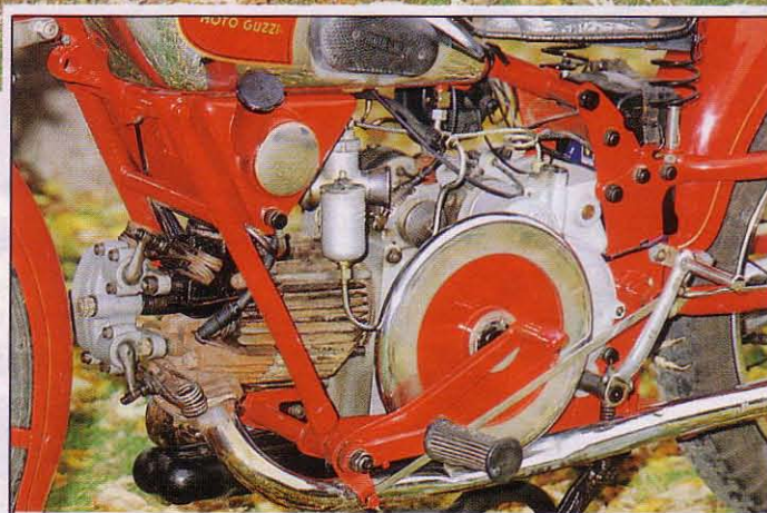
Mit Aluzylinder und gekapselten Ventilen (Modell Astore, oben) erwies sich die Vorkriegs-Konstruktion (unten) auch nach dem Krieg noch als konkurrenzfähig.
