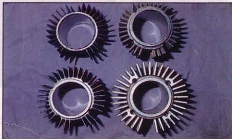
Flächenwachstum: Mit steigender Leistung vergrößerte sich auch die kühlende Oberfläche der Zylinder. Modell S (oben links), Vorkriegs-G.T.V. (oben rechts), Nachkriegs-G.T.V. (unten links) und Falcone.
