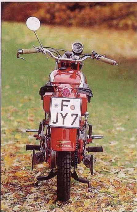
Charakteristisch für die Vorkriegs-G.T.V. mit Doppelporzylinderkopf sind die beiden Auspuffrohre.
