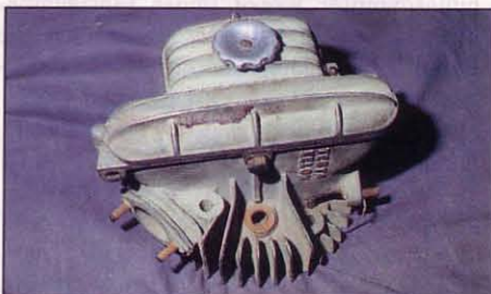
Die Firma Velox bot den Aluminium-Zylinderkopf mit gekapseltem Ventiltrieb bereits für die G.T.V. als Nachrüstsatz an — und sorgt damit noch heute für Verwirrung.
