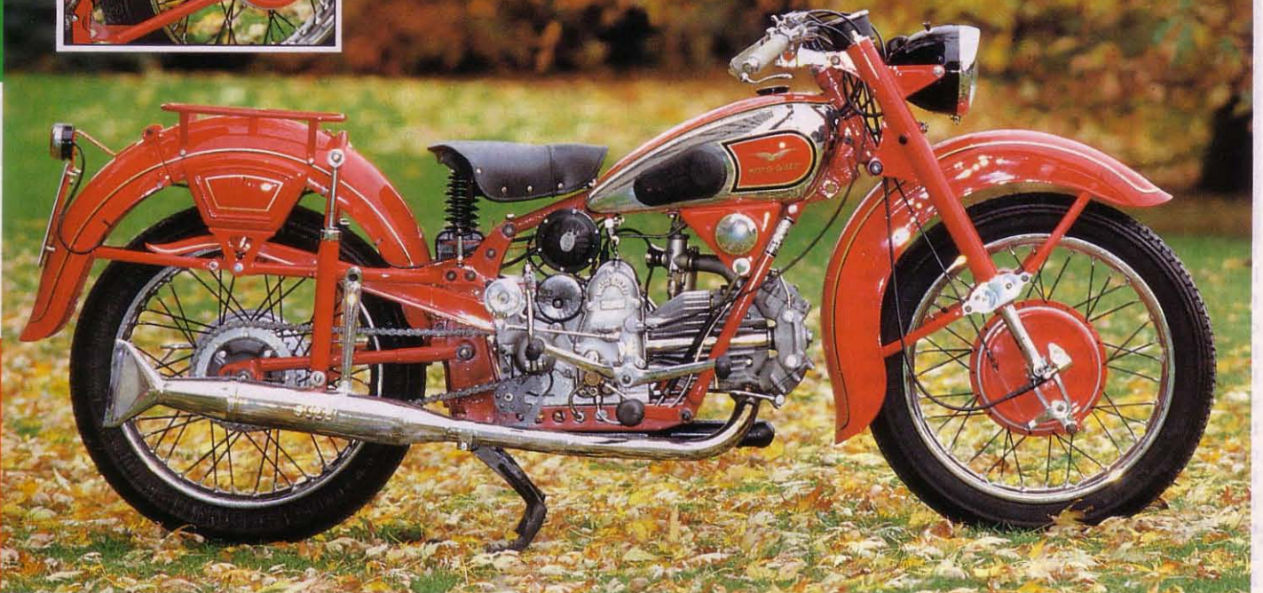
Ein spezieller Bügel verbindet die Stoßdämpfer der Astore mit dem ungefederten Teil des Rahmens. Der Zündmagnet wird per Bowdenzug von Hand verstellt, und hinter dem Scheinwerfergehäuse fehlt die zweite Gabelbrücke, wie sie später bei der Falcone zur Versteifung angebracht wurde. Der liegende Einzylinder ermöglicht eine tiefe Sitzposition und läßt die 180 Kilogramm schwere Maschine so auch für zierliche Piloten handlich bleiben.
