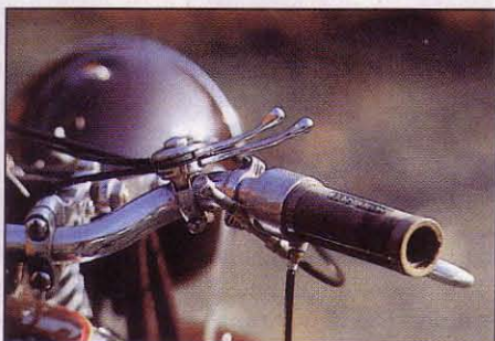
Der Abblendschalter wird mit dem Daumen bedient. Ein Bowdenzug führt vom Lenker zum Lampentopf.
