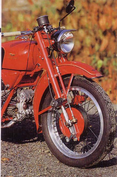
Der Originaltachometer der Falcone wird über eine Teleskopwelle angetrieben!
