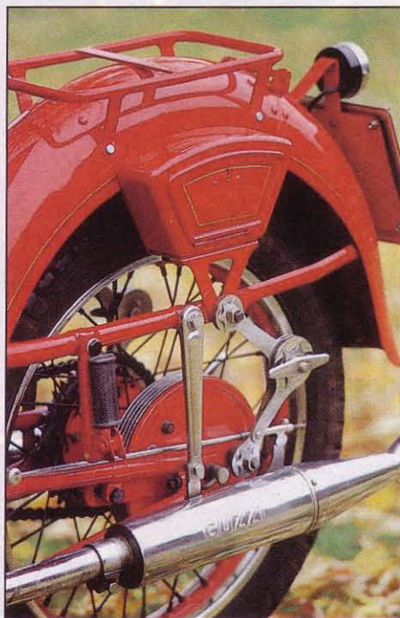
Mit je einem Handgriff auf jeder Seite läßt sich die Dämpfung der Hinterradschwinge dosieren.
