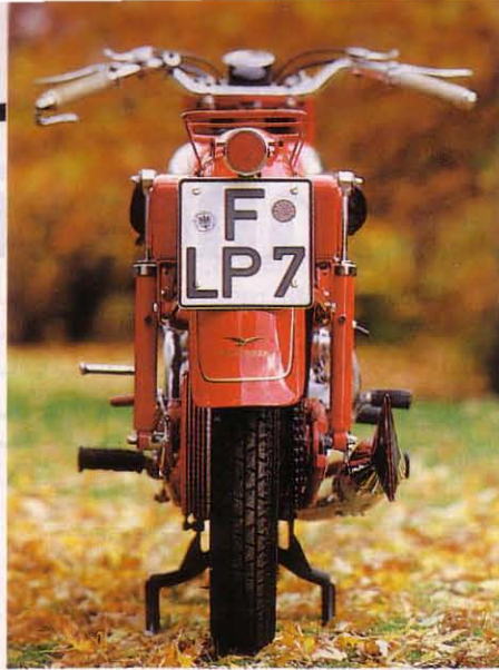
Typisch Astore: Die hydraulischen Stoßdämpfer galten seinerzeit als unsportlich.
