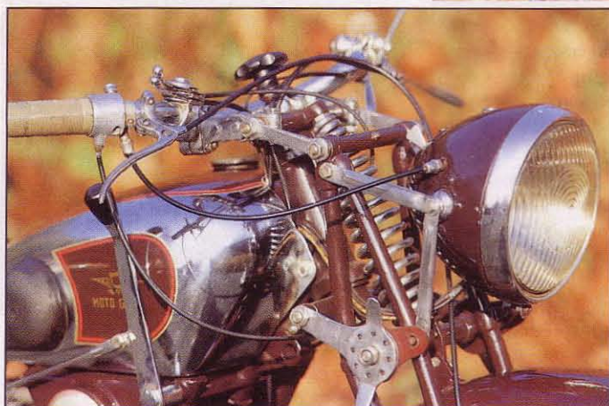
Die filigrane Gabel nach englischem Webb-Vorbild mußte die Unebenheiten der schlechten Straßen schlucken.
