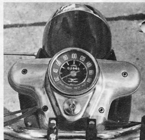
Die Seitenstütze (Bild lks.) ist serienmäßig. Das Einstellen des Ventilspiels (Bild oben) ist sehr einfach – Kipphebel-Lagerbock pro Zylinder aus einem Stück, Kipphebel in Buchsen gelagert. Sehr große Ölkanäle. In dem Tachometer sind vier Kontrollampen (Bild rechts): Leerlauf, Ladekontrolle, Standlicht-Kontrolle, Öldruck. Auf dem unteren Bild sieht man das stabile Rahmenrückgrat (Doppelrohrrahmen mit großem Mittelrohr und Kastenprofilstütze). Dazu den geöffneten linken Zylinderkopf, Vergaser, Batterie, Lichtmaschine (hinter Lichtmaschine), Anlasser usw.
