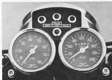
Links mechanischer Drehzahlmesser, rechts Tachometer. Vier Kontrolllampen für Zündung, Leerlauf, Oldruck und Licht.
