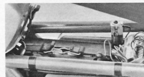
Tankbefestigung, hinten, 32 Ah-Batterie, Sicherungskasten mit Beleuchtung unter der hochklappbaren Sitzbank
