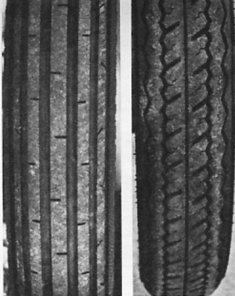
Links der Vorderradreifen mit dem durchgehenden Mittelsteg (Anlaß zur Kritik), rechts der Hinterradreifen. Fabrikat: Michelin.
