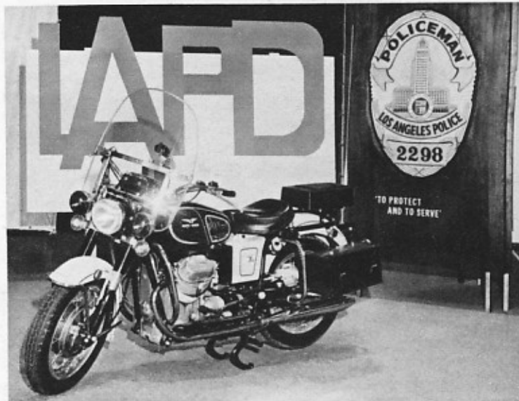
CALIFORNIA techn. Daten wie V7 Special. zuzüglich folgendem Zubehör: Trittbretter-US Lenker- hintere Sturzbügel-Einzelsitz-Großflächentachometer -Vierpunktblinkanlage - Cal. Scheibe-Lenkungsdämpfer-Chrombügel an den Zyl. Köpfen-sep. Kontrollleuchten f. Blinker Licht usw.-spezieller pol. Schnell-Seitenständer-Speziallackierung. u. v. m.
