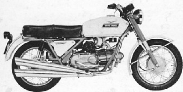
FALCONE 500 ccm 1 Zyl. 4 Takt 32 PS b. 4800 U/min. Spitze ca. 140 km „1 Jahr Motor-Garantie“
