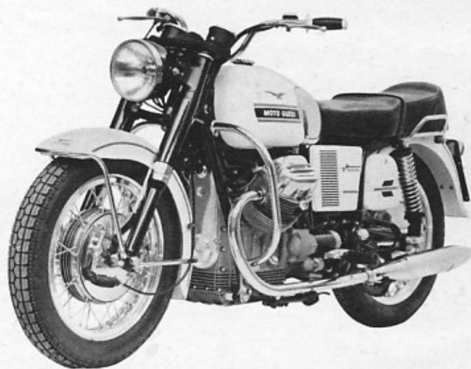
V7 Special 750 ccm 2 Zyl. V Motor Kardantrieb 60 PS b. 6500 U/min. Spitze ca. 180 km. 12 V 300 Watt Anlage. E. Starter. (Seitenwagentauglich)
