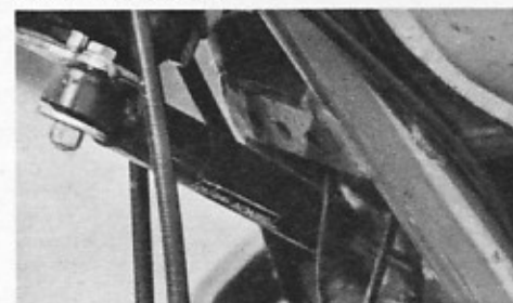
Der zuschaltbare hydraulische Lenkungsdämpfer unter dem Steuerkopf.
